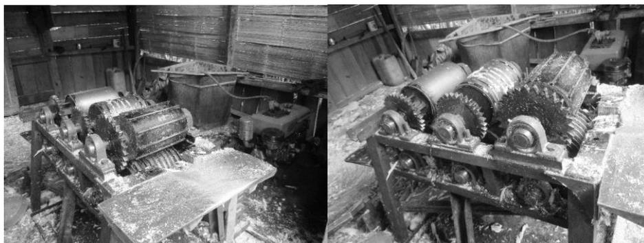
**Gambar 2.** Mesin Pengilang Tebu di Nagari Bukit Batuah
